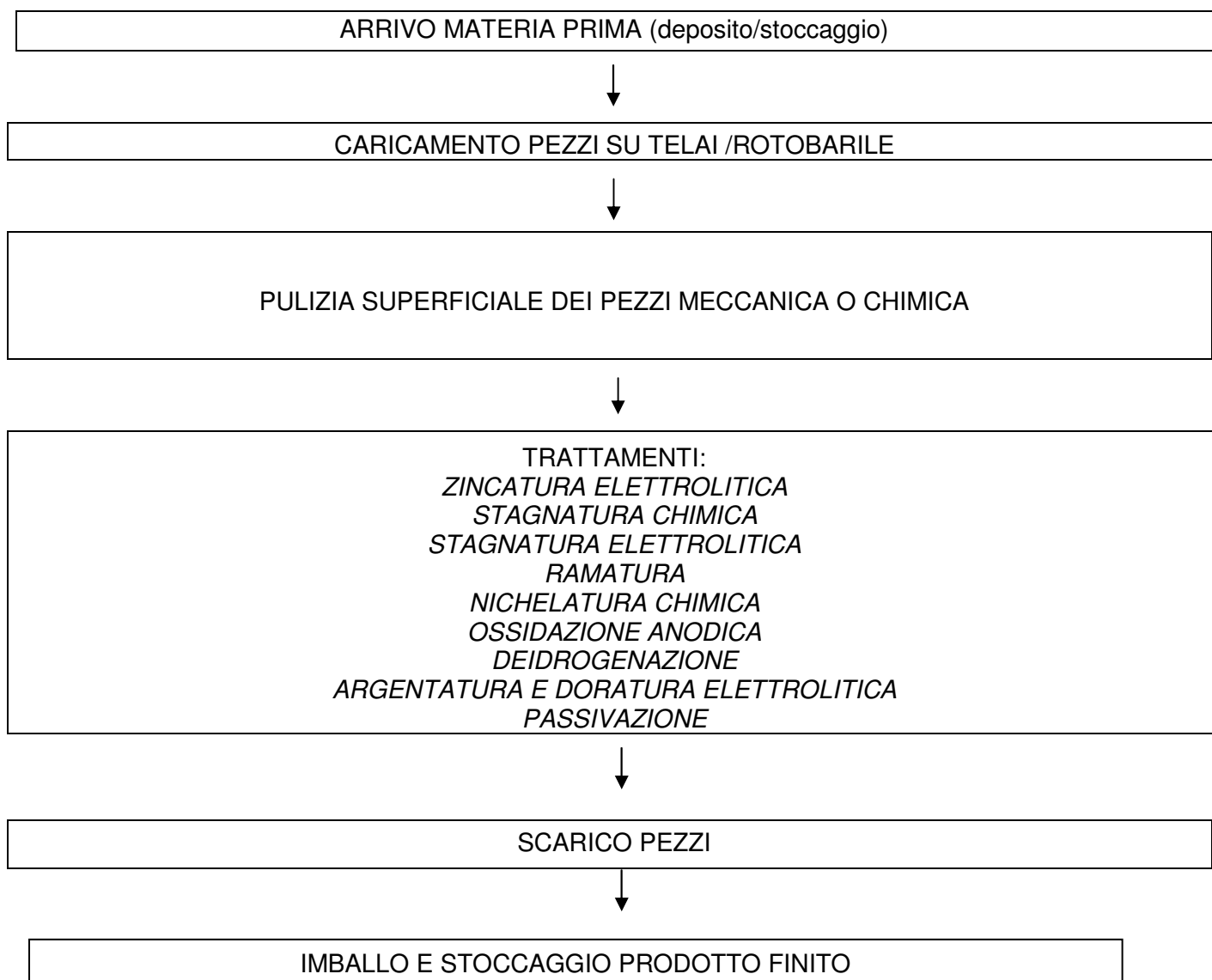
Figura B1 – Schema produttivo del processo
